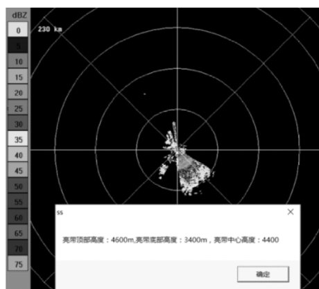
图6 2015年8月17日12:55 CD雷达的亮带识别结果(6°仰角,每个距离圈50 km,最后一圈30 km)
