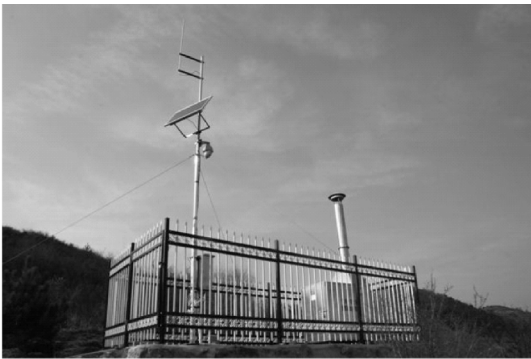
图3 地面碘化银发生器作业点实物图
