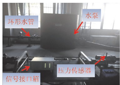
图12 基于水循环的系统联合测试 (小型发电机和井下子系统安装在环形水管内)
