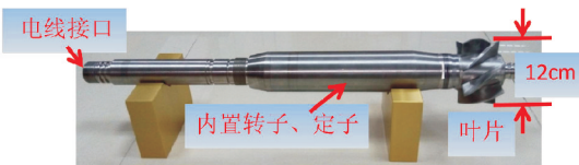
图 5 井下小型发电机实物图
