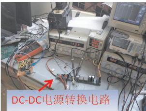
图 7 基于隔离驱动的 DC-DC 电源转换电路实物图
