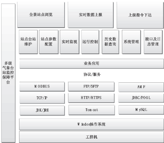
图 4 监控平台架构图
