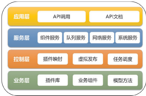
图 1 气象服务产品发布服务器总体架构
