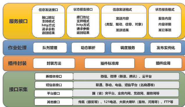
图3 气象服务产品智慧发布模型的组成结构
