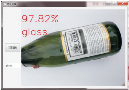
图5 ResNet50 的 glass 类测试结果
