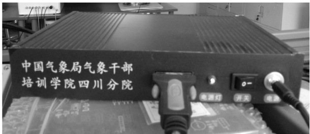
图 6 自动气象站传感器信号模拟系统整机
