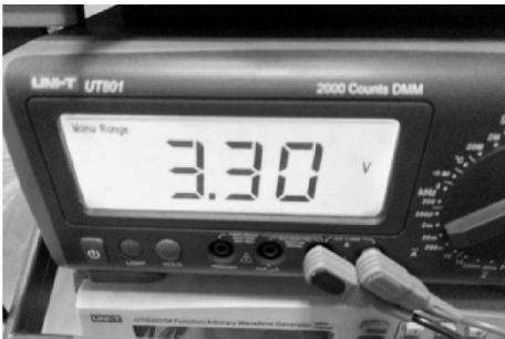
图 22 3.3 V 输出测量结果
