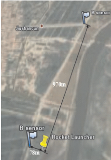
图 2 2014 年夏山东野外人工触发闪电实验基地磁场测量设备分布
