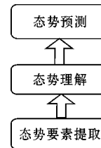
图1 网络安全态势感知3层模型
