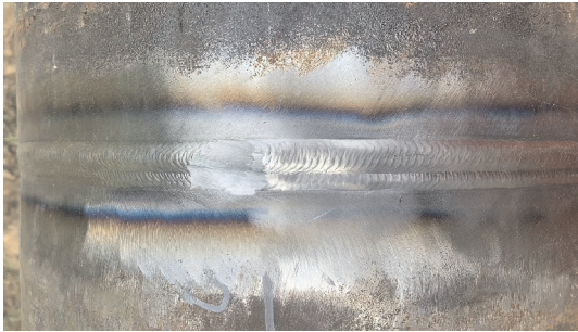
图 16 坡口成型效果
