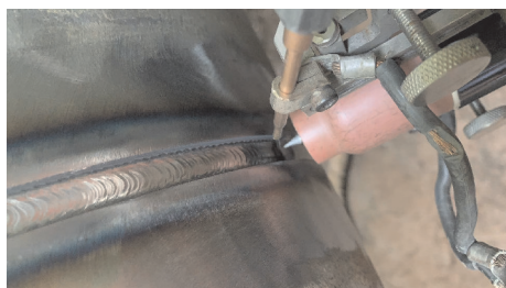
图2 焊枪与管道位置示意图
